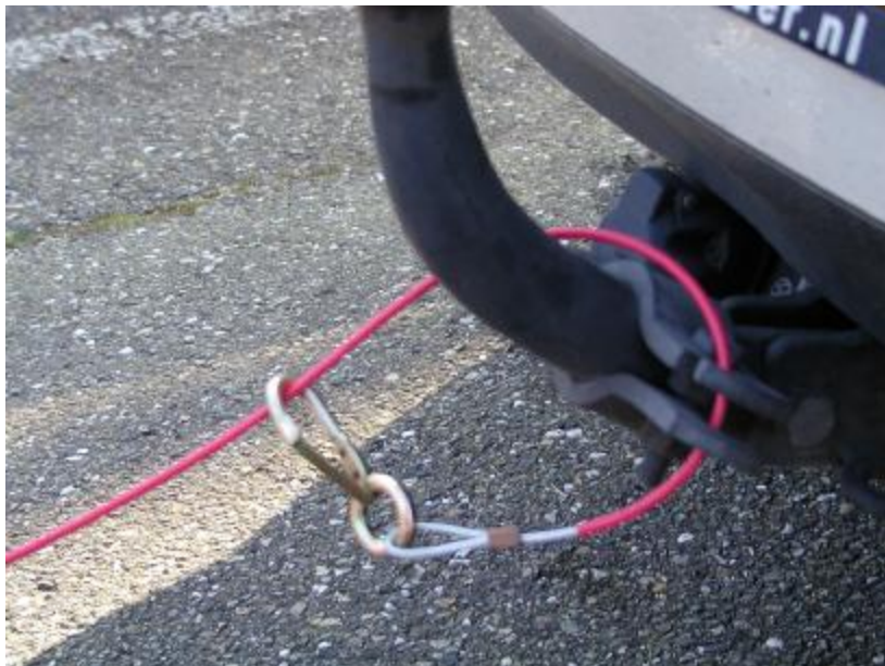
Foto : Losbreekremkabel gelust en door een bevestigingsbeugel op de trekhaak gemonteerd en musketonhaak vastgezet aan de breekkabel.
